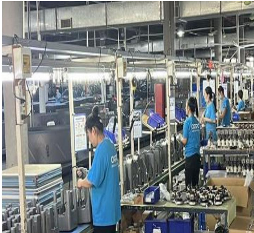
Lắp ráp bộ điều khiển bằng đinh ốc vít hoặc các linh kiện khác
