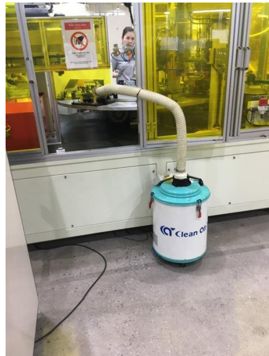
Hình 3.6. Quy trình hệ thống thu gom, xử lý khí khu vực khắc laser
