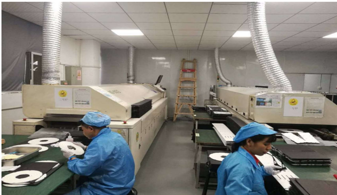
Hình 2.3. Hình ảnh ống hút khí, nguyên lý thu khí của các máy hàn tại công đoạn SMT
