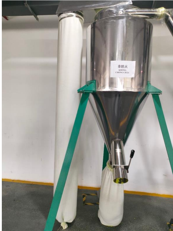
Hình 3.8. Hệ thống thu gom, xử lý bụi cho máy nghiền nhựa
