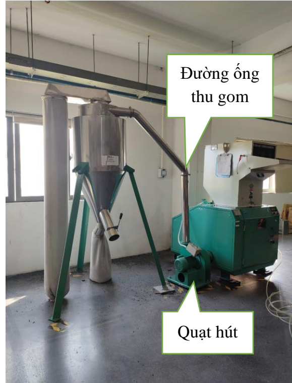
Hình 3.8. Hệ thống thu gom, xử lý bụi cho máy nghiền nhựa
