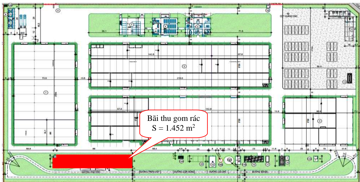
Hình 4.15. Hình ảnh vị trí kho chứa chất thải rắn công nghiệp
