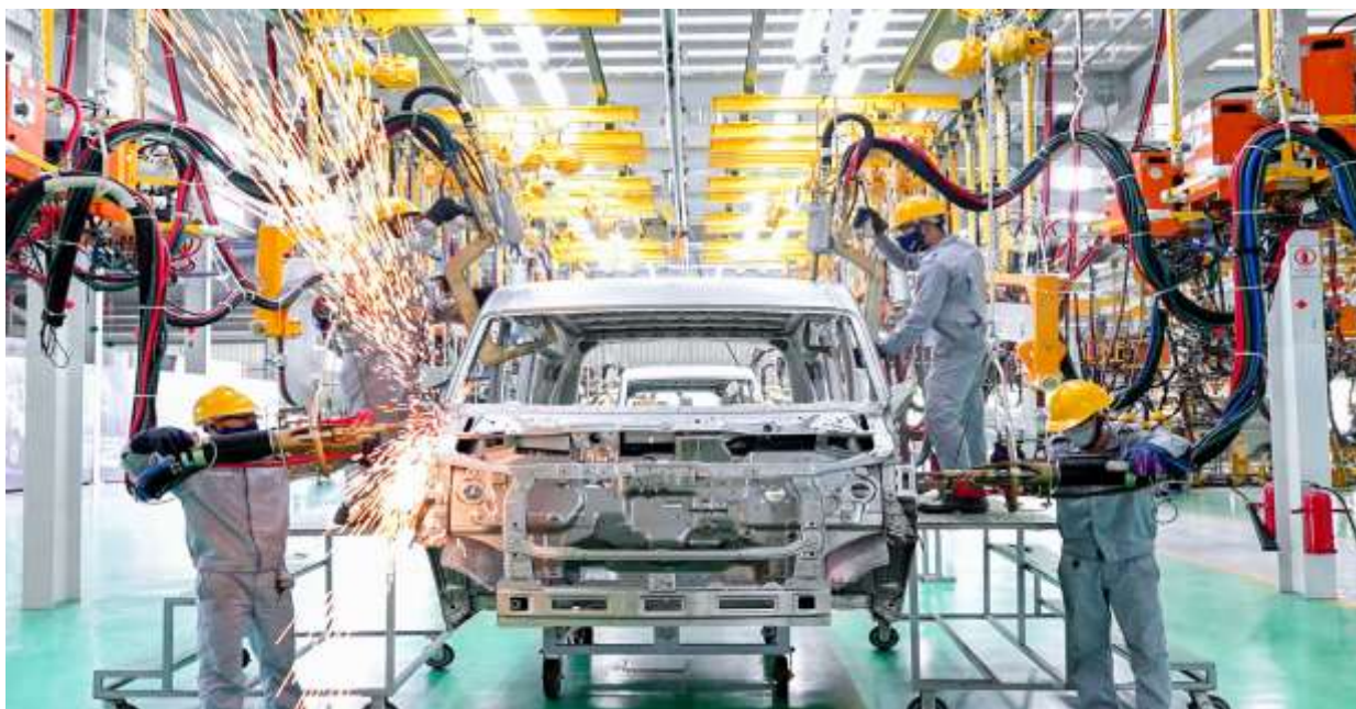
Hình 1.12. Hình ảnh mô tả công đoạn hàn
