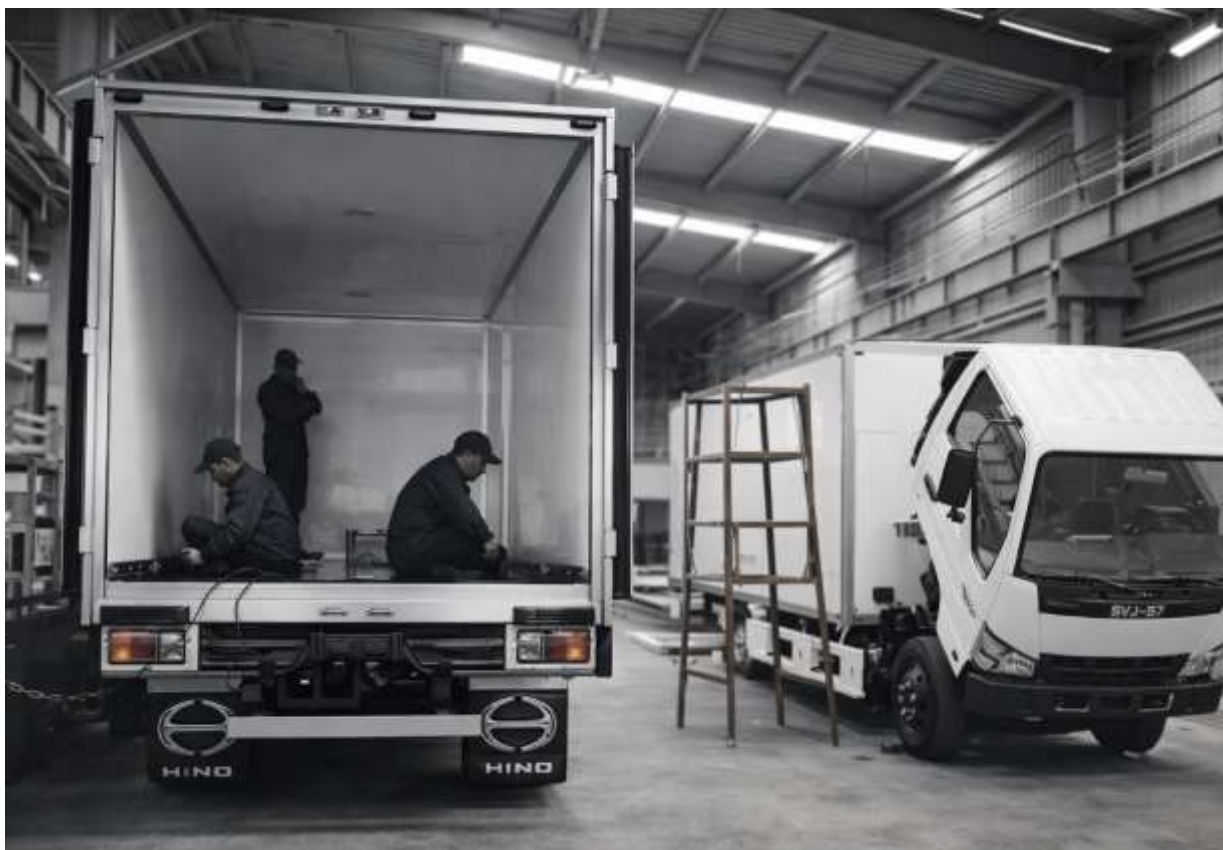
Hình 1.22. Hình ảnh minh họa dây chuyền lắp ráp thùng xe ô tô
