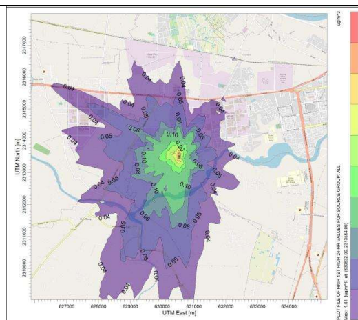
Hình 4. Nồng độ Styrene lớn nhất 24 giờ trường hợp các hệ thống xử lý khí thải hoạt động ổn định
