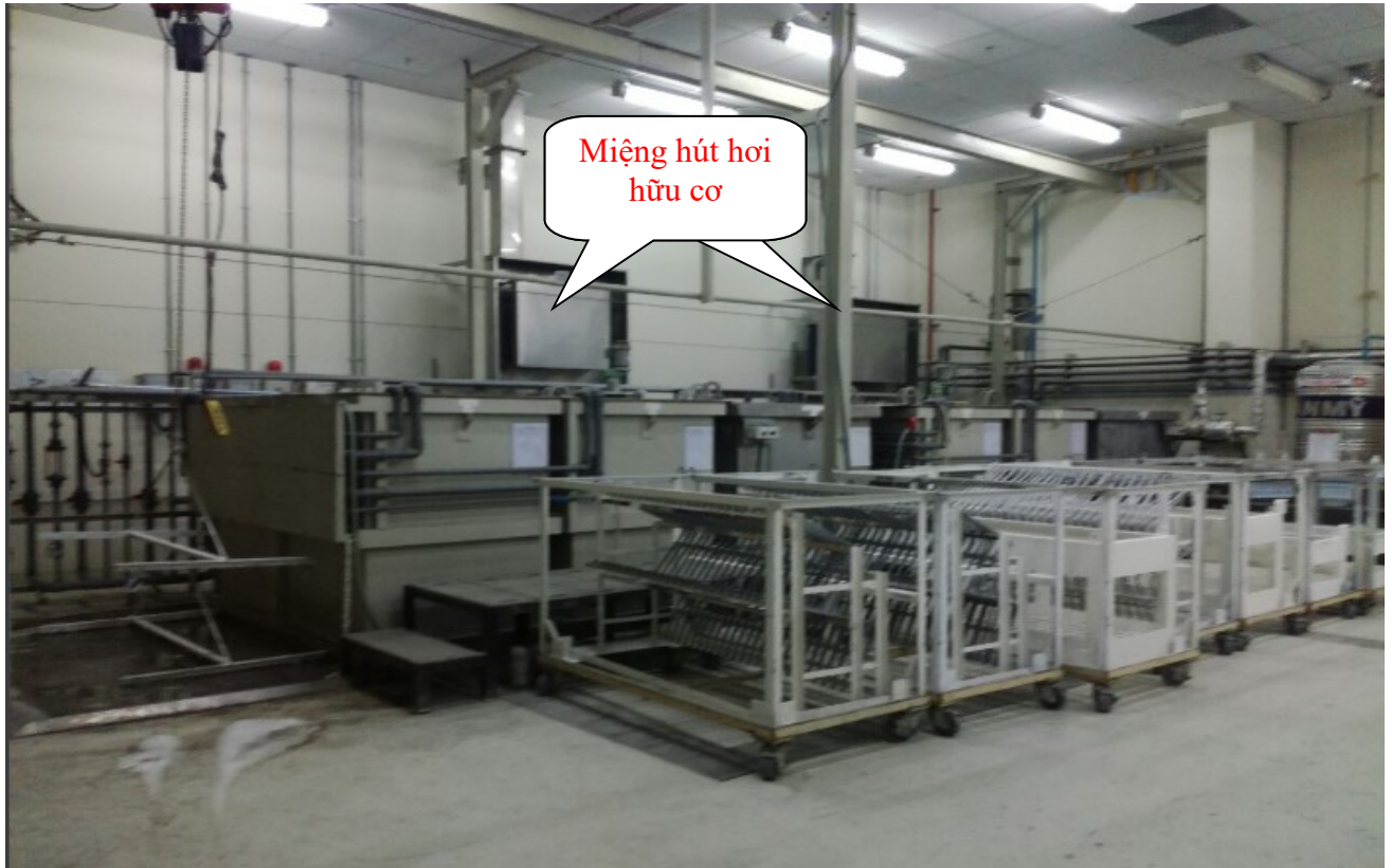
Hình 3.9. Hình ảnh hệ thống làm sạch bộ phận bếp ga trước khi sơn
