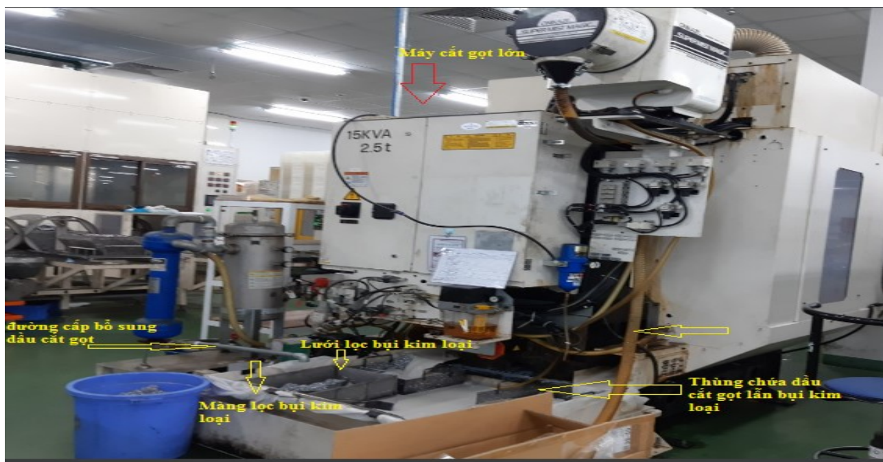
Hình 3.12. Thiết bị thu gom, lọc bụi và tuần hoàn dầu bôi trơn
