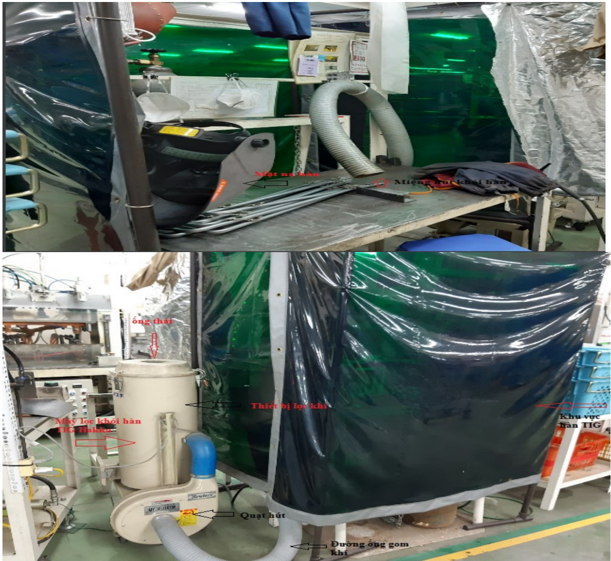
Hình 3.8. Hình ảnh khu hàn TIG tại khu vực gia công ống dẫn ga
