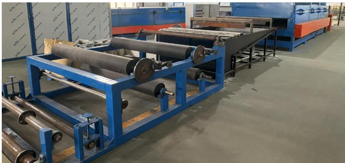
Hình 10. Hình ảnh mô phỏng dây chuyền nhúng sơn tại cơ sở
