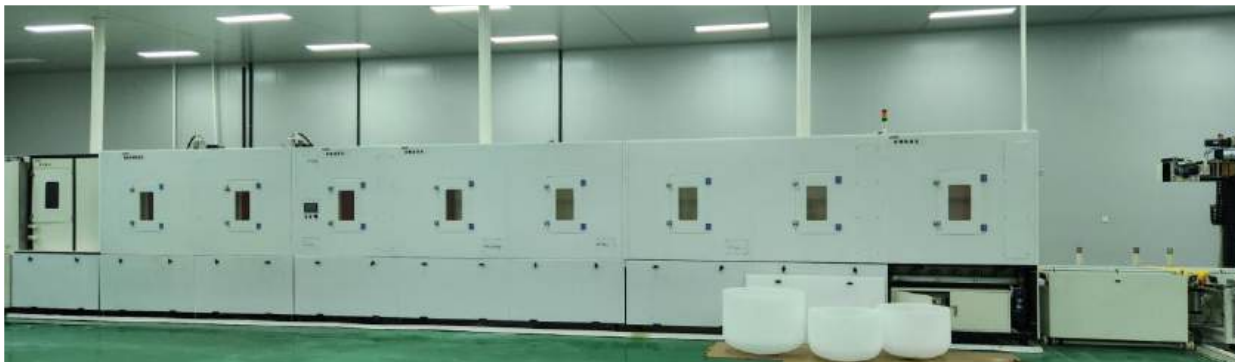
Hình 1.15. Hệ thống rửa HF
