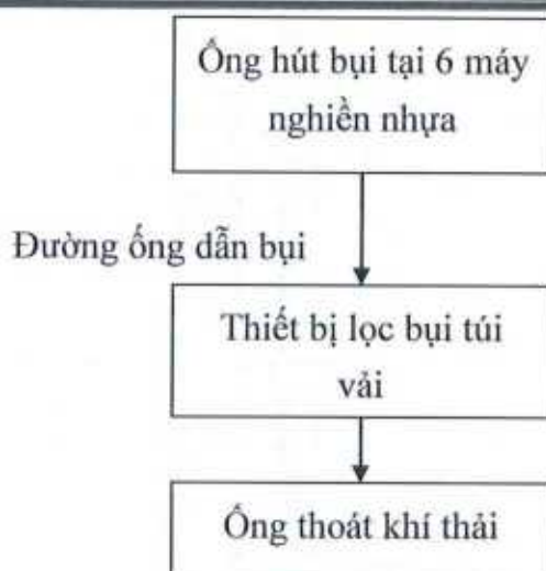
Hình 3.15. Sơ đồ quy trình xử lý bụi cho công đoạn nghiền nhựa
