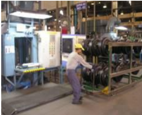
(1) Công nhân chuyển lốp tươi đến khu vực Doping bằng xe đẩy
