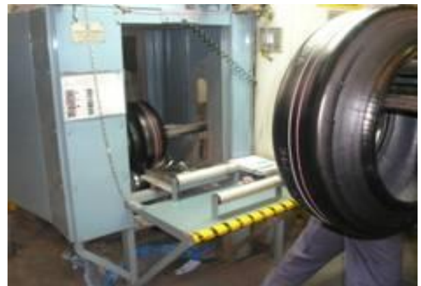
(3) Lốp tươi được đưa vào máy doping
