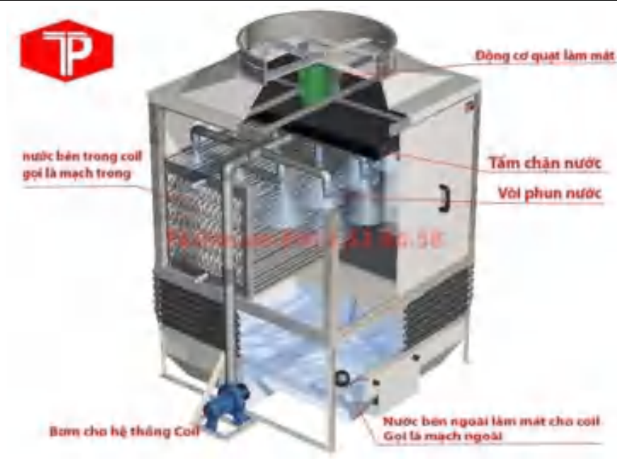
Hình 3. 11. Nguyên lý hoạt động của tháp giải nhiệt
