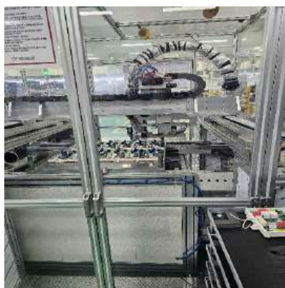
Phủ keo bảo vệ bằng cánh tay robot
