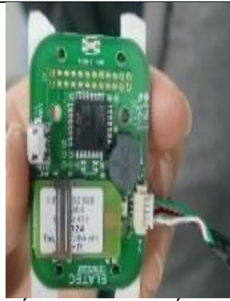
Lắp ráp các chi tiết điện tử lên cửa trước trụ sạc
