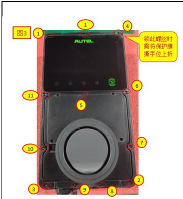
Lắp đặt vỏ trên và vỏ dưới (bắt vít) và chắm kéo 8512
