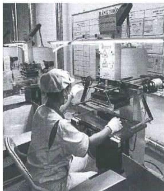
+ Lắp ráp: Tùy vào yêu cầu của từng sản phẩm, Dự án có khoảng 15% các sản phẩm cần lắp ráp, các chi tiết từ các công đoạn phía trên sẽ được chuyển đến khu vực lắp ráp để công nhân thực hiện lắp ráp thủ công. Các linh kiện chủ yếu đã có sẵn các khớp nối, khớp xoắn hoặc bắt ốc, vít, do đó, công đoạn này không sử dụng keo hay hóa chất khác để lắp ráp. Công nhân chỉ cần đặt các linh kiện theo đúng thứ tự và lắp lại với nhau.
