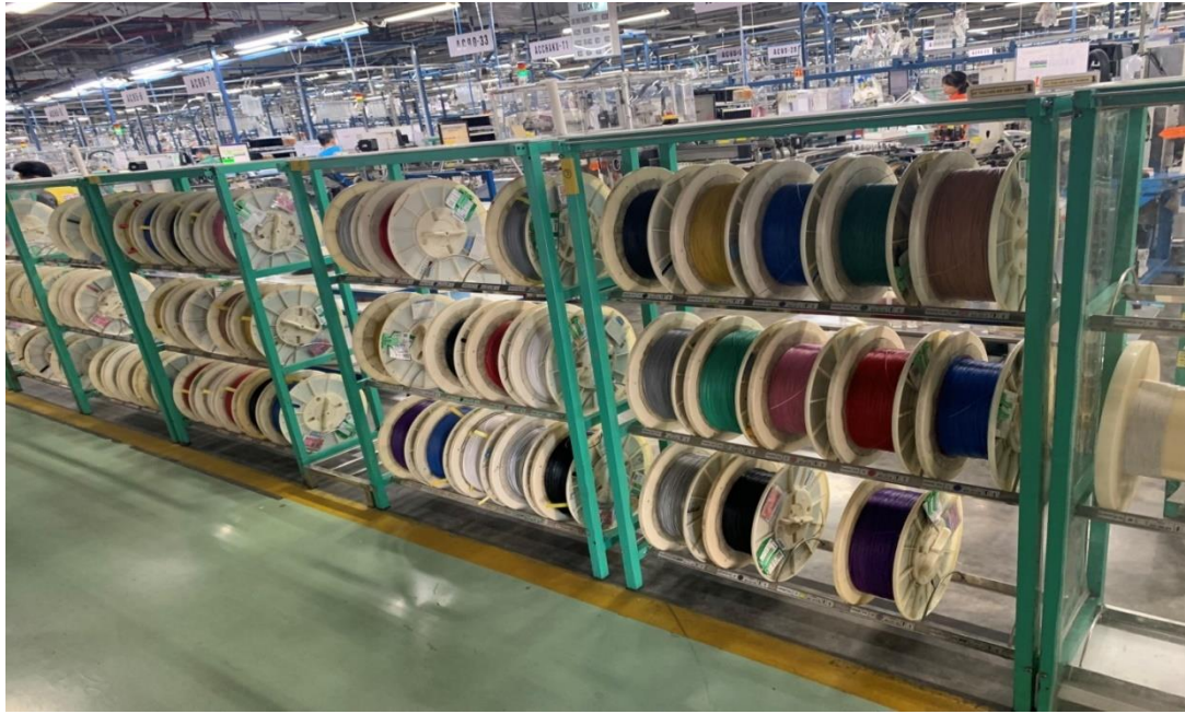
Các cuộn dây điện tại công đoạn cắt dây
