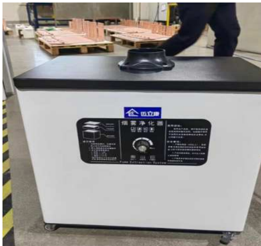
工作原理介绍 物理主动四层净化过滤，由涡轮风机产生吸力吸入污染物 经过四层过滤装置净化后，洁净的空气直接通过机器背部排出
