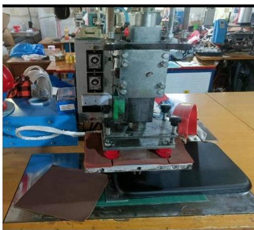
In logo bằng phương pháp ép nhiệt
