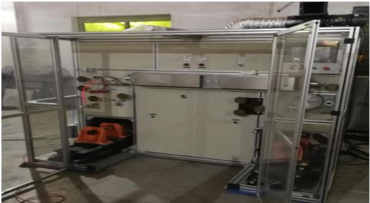
Hình 1.5. Hình ảnh máy phủ màu sợi quang được sử dụng tại nhà máy
