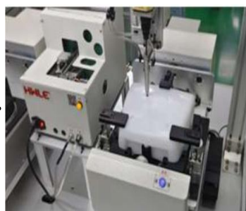
Bắt vít, lắp ráp
