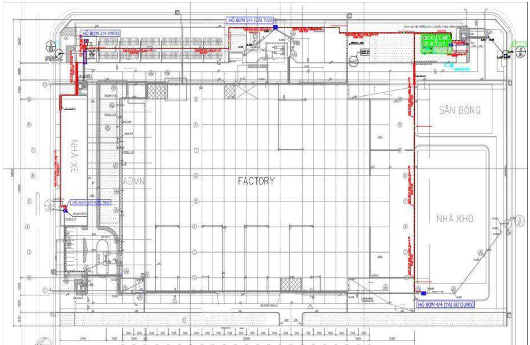
Hình 13. Sơ đồ thu gom nước thải Lô M
