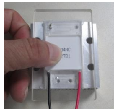
Gắn chip lạnh vào cục nhôm tản nhiệt
