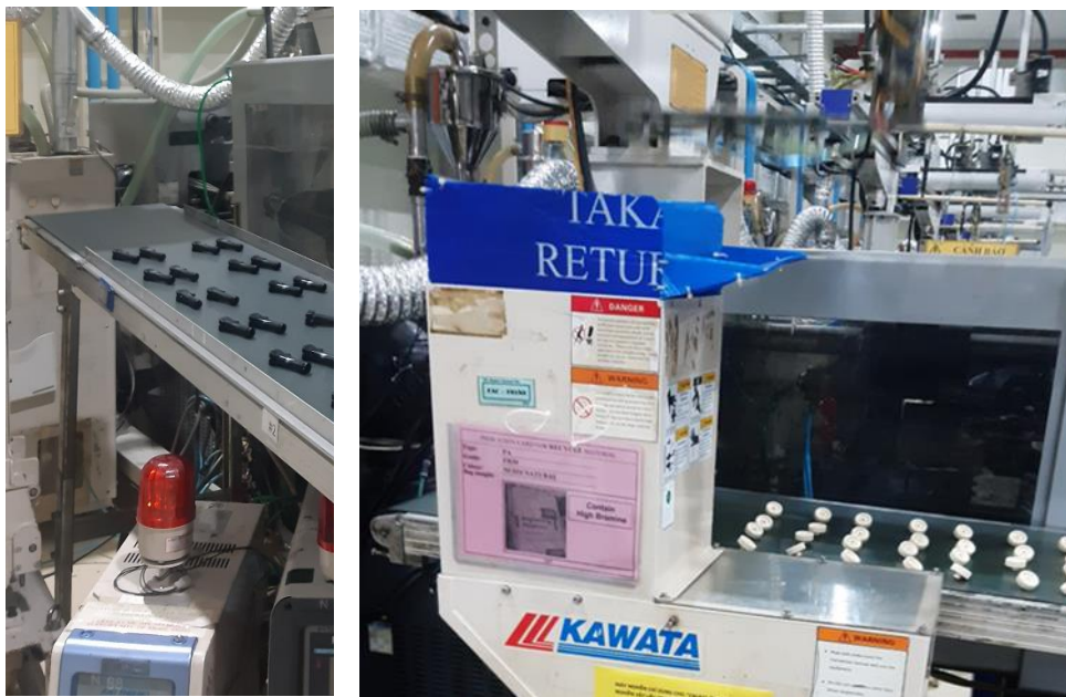
Hình 5. Sản phẩm sau khi đúc xong được robot gắp ra băng chuyền
