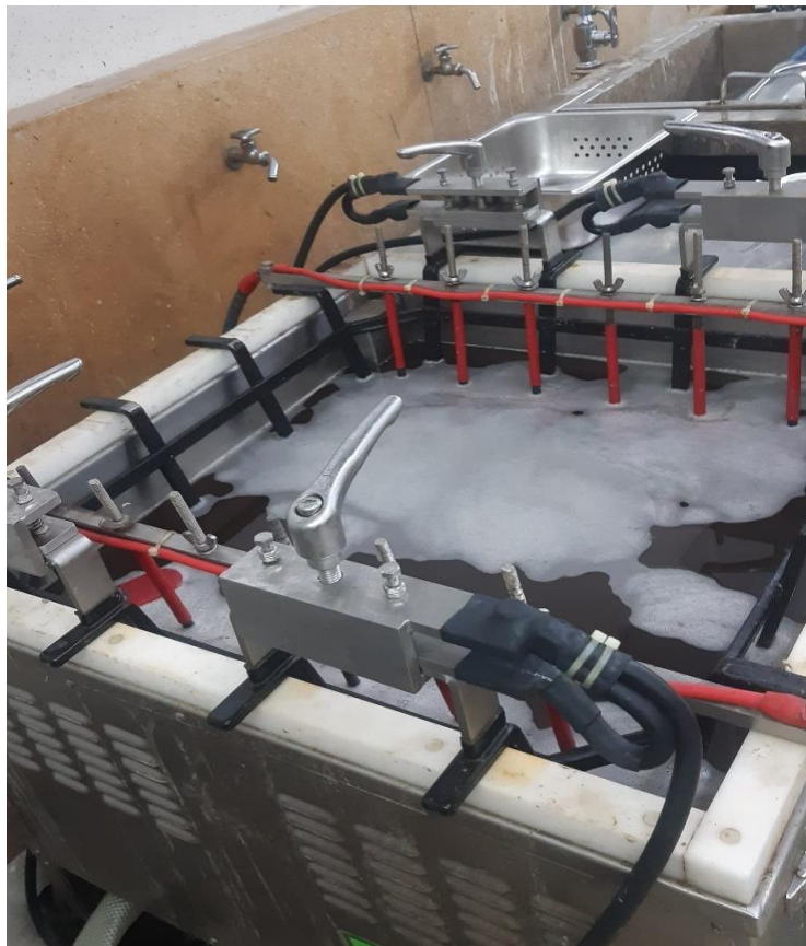
Hình 10. Bể điện phân làm sạch bề mặt khuôn
