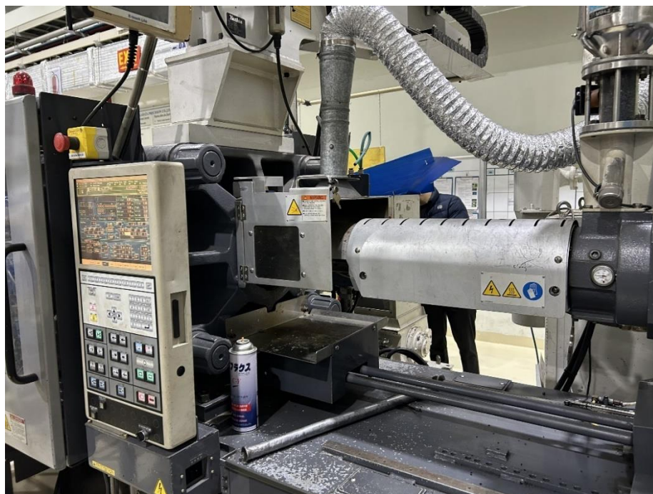
Hình 3. Bộ phận ren vít và gia nhiệt của máy đúc nhựa
