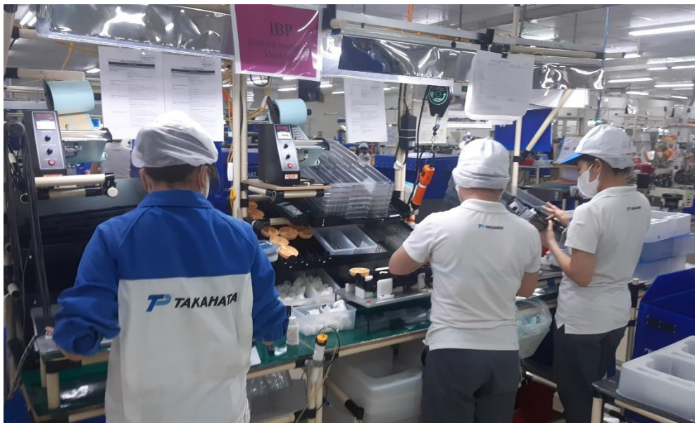
Hình 7. Công nhân lắp ráp các linh kiện trước khi đưa vào máy hàn rung
