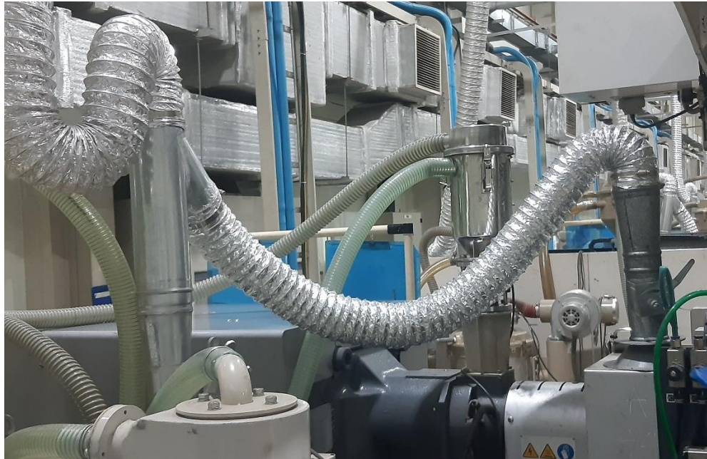
Hình 31. Ống hút khí thải phát sinh từ máy đúc nhựa
