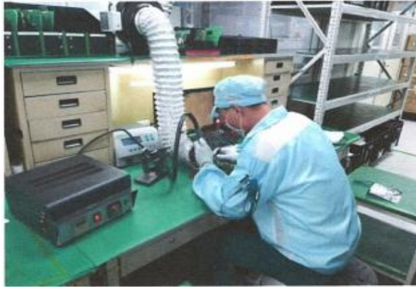
Hình 1.9. Hình ảnh sửa chữa trong công đoạn SMT và DIP
