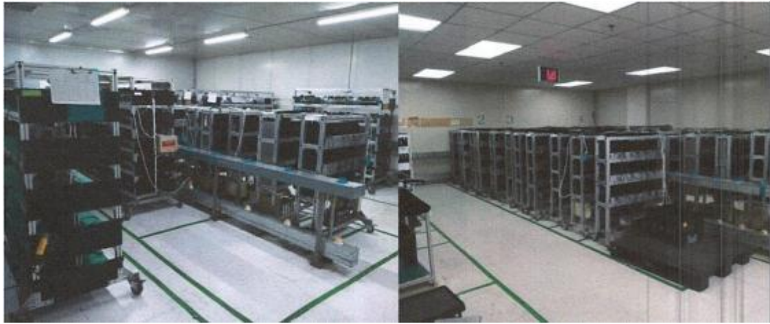
Hình 1.13. Công đoạn thử độ bền sản phẩm Burn in/Run in
