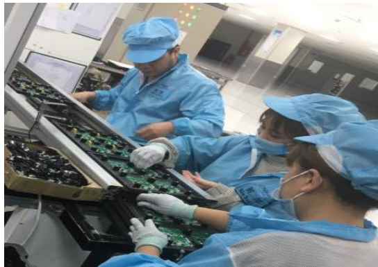
Hình 1.10. Hình ảnh sửa chữa trong công đoạn SMT và DIP
