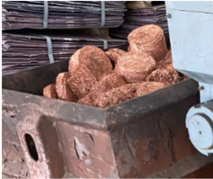
Chip đồng tạo thành từ quá trình ép
