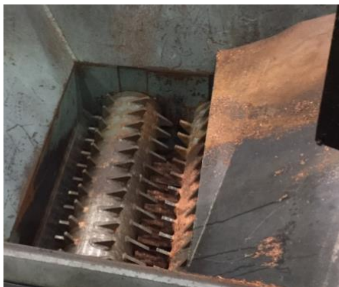
Vụn đồng rơi xuống phễu thu gom của thiết bị
