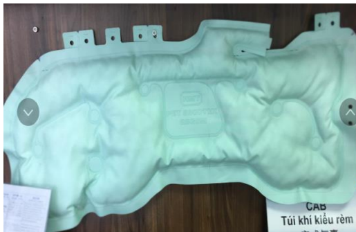
Bộ túi khí an toàn không đường may OPW
