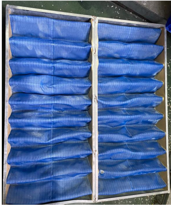
Hình ảnh tấm lọc bằng sợi thủy tinh của hệ thống xử lý khí thải khu vực cắt lazer
