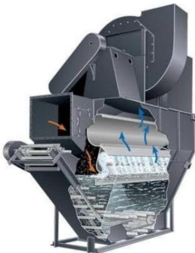
Hình 17. Hệ thống xử lý bụi tại các máy đánh bóng của dự án bằng công nghệ lọc bụi dạng ướt
