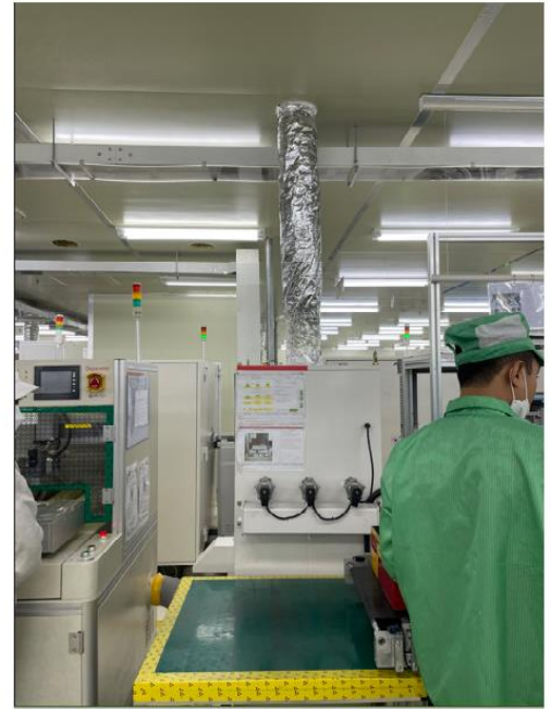
Các máy tách băng mạch: máy 2 ống dẫn và máy 1 ống dẫn sau khi qua hệ thống lọc bụi đồng bộ với máy
