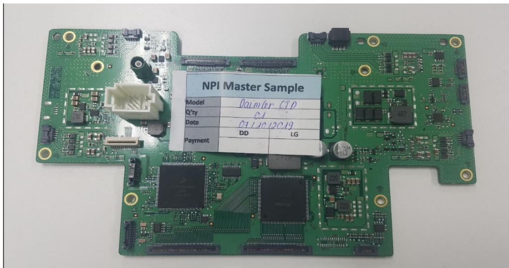
Bảng mạch chủ cho các thiết bị giải trí trên ô tô
