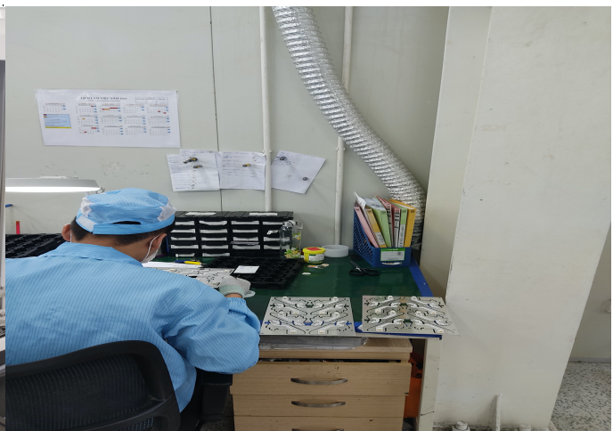
Công đoạn hàn tay đối với các sản phẩm lỗi
